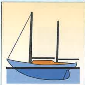
Ketch - dua mast, mizzen lebih pendek dan di hadapan rudder
