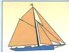
GAFF-RIGGED CUTTER - Satu mast, gaff-rigged dengan dua atau lebih foresail
